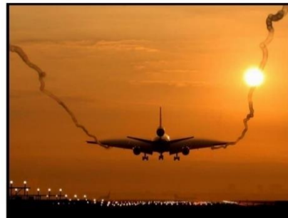
Tourbillon marginaux (vortex) ; au soleil couchant, noter les deux tourbillons des volets et la répartition elliptique de la portance matérialisée par la condensation de l'humidité de l'air.
