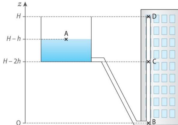
Un réservoir d'eau contient une hauteur d'eau  $h$ ,  $A$  est un point de la surface de l'eau, à l'altitude  $H - h$ . La hauteur d'eau  $h$  restant constante, la vitesse  $v_A$  de l'eau en ce point est nulle.  $B$ ,  $C$  et  $D$  désignent trois robinets, dont la section de sortie a pour aire  $s = 11 \text{ mm}^2$ , aux altitudes respectives  $z_B = 0 \text{ m}$ ,  $z_C = H - 2h$  et  $z_D = H$ .
