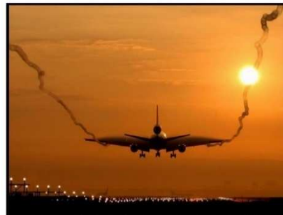
Tourbillon marginaux (vortex) ; au soleil couchant, noter les deux tourbillons des volets et la répartition elliptique de la portance matérialisée par la condensation de l'humidité de l'air.
