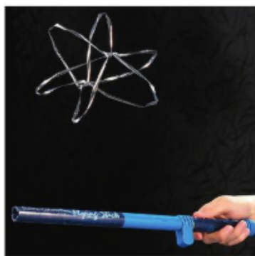
Cette « baguette magique » électrostatique utilise aussi un générateur de Van de Graaff pour créer un champ électrique.
