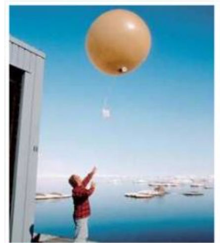
Fig. 4 Les ballons-sondes effectuent des mesures jusqu'à 50 km au-dessus du sol.
