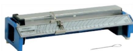
Doc. 3 Le banc Kofler est un appareil de mesure permettant de mesurer la température de fusion d'une substance solide.
