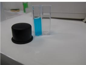
Deux cuves (une référence et une solution à mesurer) et le capot bloquant la lumière du jour lors d'une mesure.
