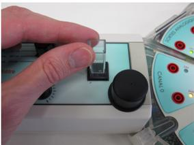
La cuve du colorimètre, placée dans son support de mesure, le bouchon noir est à poser sur la cuve avant toute mesure (bloque la lumière du jour).
