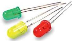
Dans le matériau semi-conducteur qui la constitue, un électron de la bande de conduction peut passer dans la bande de valence. Il y a alors émission d'un photon d'énergie égale à l'écart énergétique  $\Delta E$  entre ces deux bandes.
