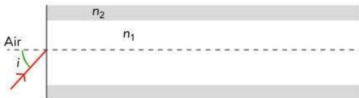
Une fibre optique à saut d'indice est constituée d'un cœur cylindrique transparent d'indice  $n_1$  entouré d'une gaine transparente d'indice  $n_2$  et d'une protection opaque.
