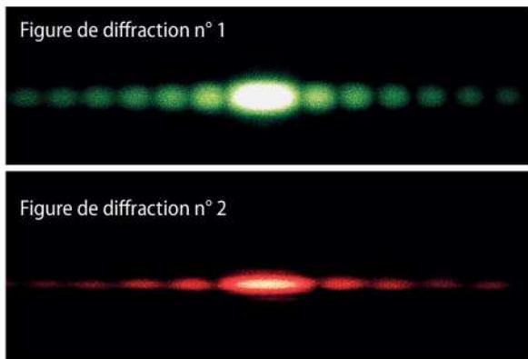
Sachant que le laser rouge utilisé a une longueur d'onde  $\lambda_R = 632,8 \text{ nm}$ , déterminer celle  $\lambda_V$  du laser vert.
