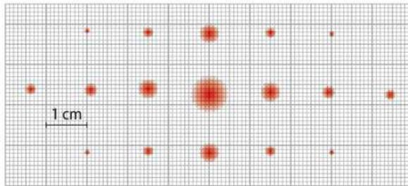
Cette figure est assimilable à une figure d'interférences à deux dimensions : l'interfrange  $i$ , distance entre deux points lumineux consécutifs sur l'axe horizontal ou sur l'axe vertical, est lié à la distance  $b$  entre les centres de deux miroirs sur l'un ou l'autre de ces axes et à la longueur d'onde  $\lambda$  :
