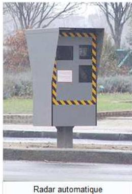
*Un Radar (Radio Detection And Ranging) de contrôle routier est un appareil servant à mesurer la vitesse des véhicules circulant sur la voie publique à l'aide d'ondes électromagnétiques radio. Un radar type Mesta émet une onde continue de fréquence 24,150 GHz qui est réfléchi par la voiture se trouvant dans la direction pointée.*
