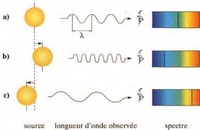
Décalage du spectre vers les courtes longueurs d'onde (BLEU) pour un objet lumineux qui se rapproche de l'observateur
