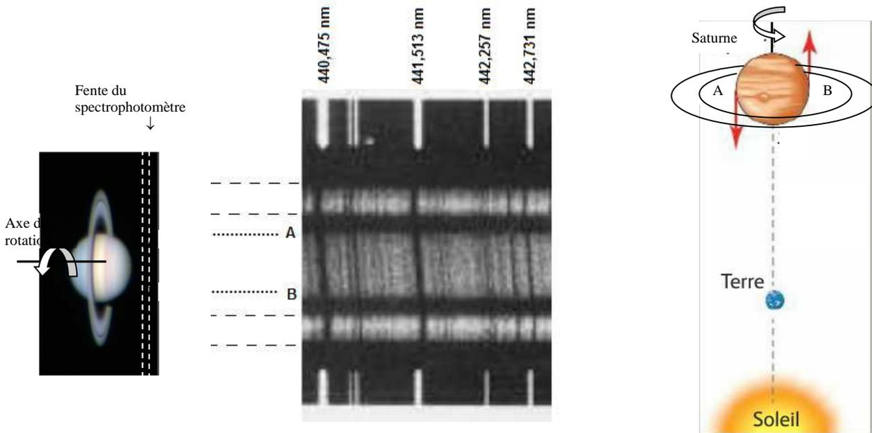
La fente du spectrographe permet d'isoler une bande étroite comprenant le centre de Saturne et ses anneaux selon la figure ci-dessus.
