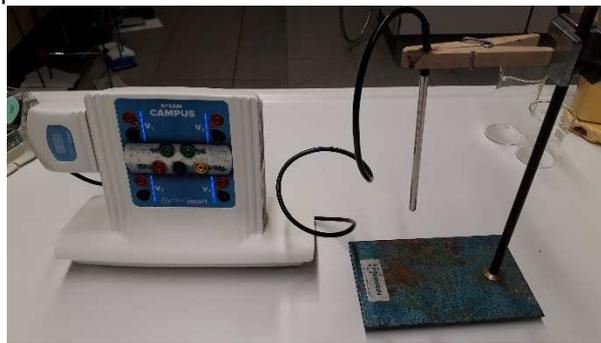
Au contact de l'air, assimilé à un **thermostat \***, un corps chaud se refroidit progressivement. Le temps caractéristique de refroidissement dépend du coefficient  $h$  de transfert conducto-convectif.
