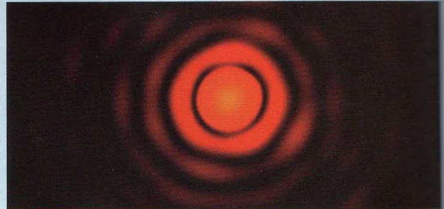
Fig. 1 Figure de diffraction observée lors du passage d'un faisceau laser à travers un trou (sa première observation date de 1665).
