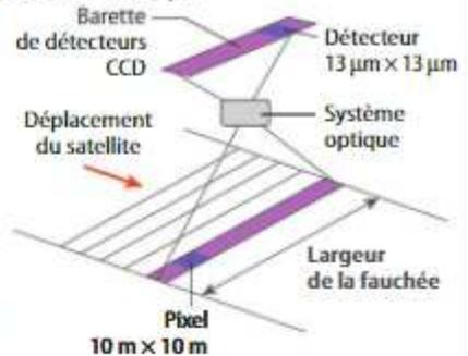
En mode panchromatique, les images réalisées par le satellite SPOT sont recueillies sur une barrette constituée de 6 000 détecteurs CCD et numérisées en niveaux de gris. Chaque détecteur est un carré de  $13 \mu\text{m}$  de côté recueillant l'information provenant d'une zone terrestre de 10 m de côté.
