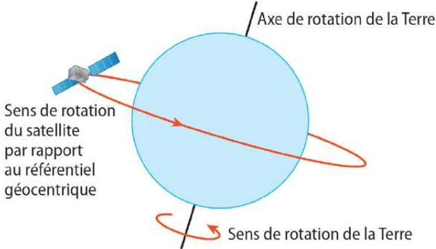
1.4. La période de SPOT est  $T_S = 101,4$  min. Sa vitesse par rapport au référentiel géocentrique a donc pour norme  $v = \frac{2\pi(R_T + h_S)}{T_S} = 7,45 \times 10^3 \text{ m}\cdot\text{s}^{-1}$ .
