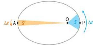
D'après la deuxième loi de Kepler, si l'aire balayée pendant la même durée reste la même, alors la vitesse du satellite est la plus élevée au périastre, P sur le schéma, et la plus faible à l'apoastre, A sur le schéma.
