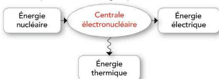
Le cœur du réacteur fournit à la centrale une énergie thermique  $Q$ . L'eau du circuit de refroidissement est à la température initiale  $T = 16\text{ °C}$  et la centrale lui fournit une énergie thermique  $Q'$ . Le travail électrique fourni par la centrale au réseau électrique est noté  $W$ . Le rendement de conversion de la centrale vaut 33 %.
