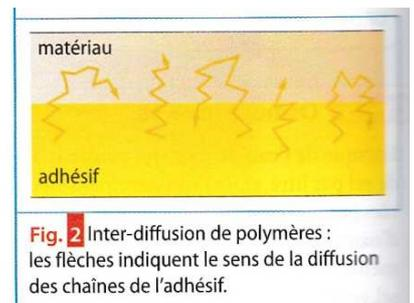
Fig. 2 Inter-diffusion de polymères : les flèches indiquent le sens de la diffusion des chaînes de l'adhésif.
