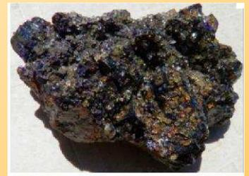
La première étape est le grillage : pour éliminer une grande partie du soufre, la blende est chauffée en présence d'air. Il se forme des oxydes comme  $\text{ZnO}$  (s) ,  $\text{Fe}_2\text{O}_3$  (s) ,  $\text{CuO}$  (s) ,  $\text{PbO}$  (s) ; le minerai de zinc et ses impuretés, après grillage, est appelée la calcine.
