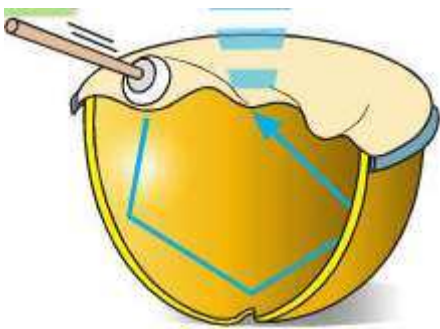
Coupe d'une timbale : schématisation du trajet du son en bleu.
