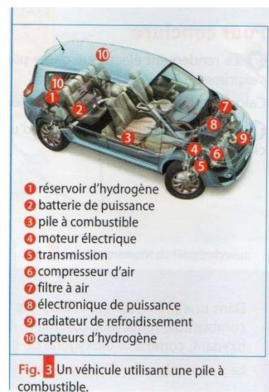
Fig. 3 Un véhicule utilisant une pile à combustible.
