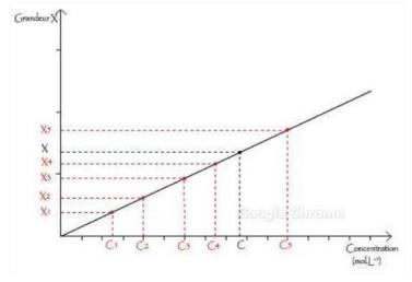
Le graphique ci-contre représente une courbe d'étalonnage linéaire (ce qui est souvent le cas). Elle a été tracée en utilisant des solutions étalons de concentration C1,  $C_2$ ,  $C_3$ ,  $C_4$  et  $C_5$  associées respectivement à des grandeurs  $X_1$ ,  $X_2$ ,  $X_3$ ,  $X_4$  et  $X_5$ .
