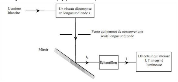
Sur un spectrophotomètre **monofaisceau**, il faut faire **le réglage du zéro** ou réaliser « **un blanc**». Cela consiste à faire une mesure de l'absorbance de l'ensemble [cuve, solvant] **sans l'espèce colorée** puis à régler le zéro d'absorbance sur la valeur correspondante.
