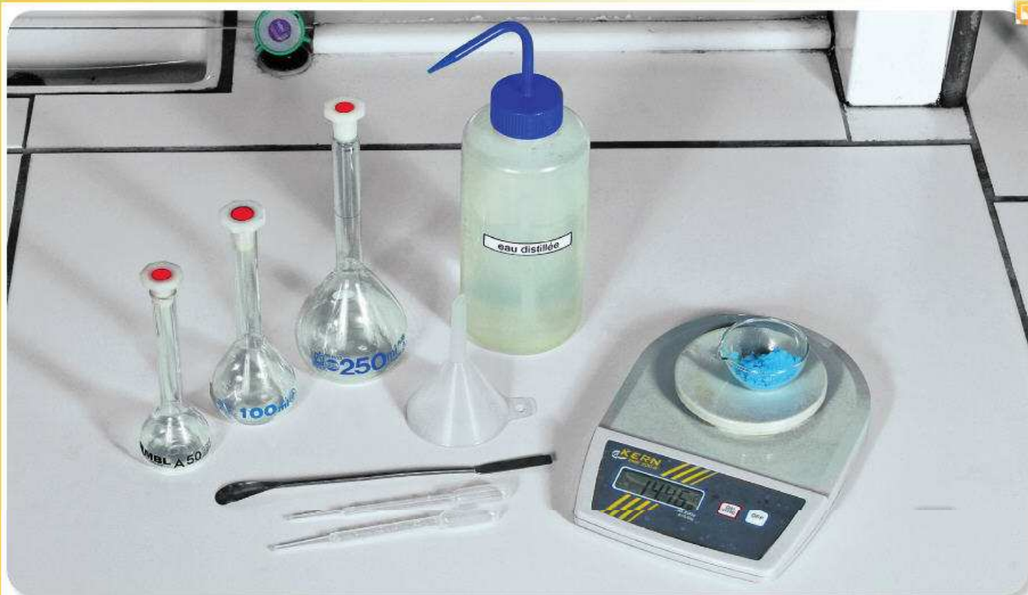
Doc. 1 Matériel à utiliser pour la préparation d'une solution par dissolution.
