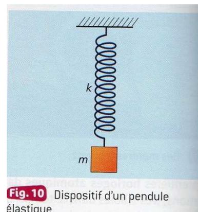
**Fig. 10** Dispositif d'un pendule élastique.
