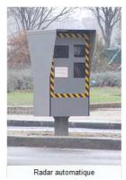
Un **Radar** (**Ra**dio **D**etection And **Ra**nging) de contrôle routier est un appareil servant à mesurer la vitesse des véhicules circulant sur la voie publique à l'aide d'ondes électromagnétiques radio. Un radar type Mesta émet une onde continue de fréquence 24,150 GHz qui est réfléchie par la voiture se trouvant dans la direction pointée.
