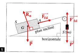
**A** Déterminer les forces appliquées au solide *S* en supposant que le contact avec le plan incliné est sans frottement.
