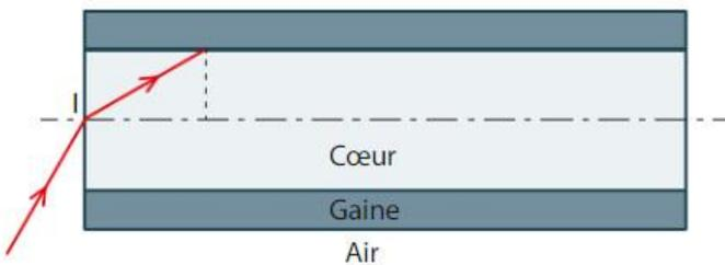
**21** Un rayon lumineux se propageant dans l'air arrive sur une face plane d'un bloc de verre.
