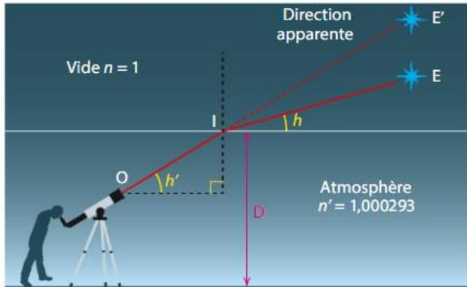
Nous assimilerons l'atmosphère à une couche transparente d'indice de réfraction  $n' = 1,000293$ . L'astrophysicien visant l'étoile  $E$  trouve une hauteur apparente  $h'$  égale à  $42,0000^\circ$ . Cette valeur est différente de la hauteur  $h$  à cause de la réfraction atmosphérique.
